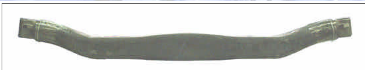
Foto 1) – Assale Idroformato in esame.
